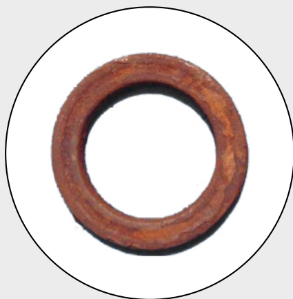
Reggispira sospensione intaccata a seguito dell'ingresso di contaminanti
