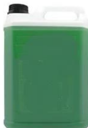
Chłodziwo t -25°C / -30°C / uniwersalne, zielone , na ogół na bazie glikolu etylenowego z dodatkiem inhibitorów korozji.
