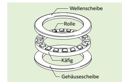
Abb. 5.7 Axialrollenlager
