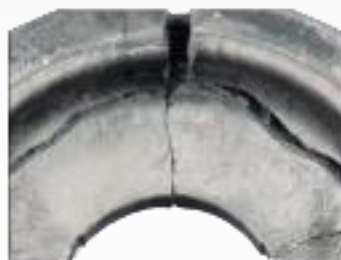
Butée de choc défectueuse :
