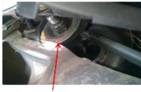
Ensemble butée et bloc de mauvaise qualité Tige d'amortisseur transperçant la carrosserie
