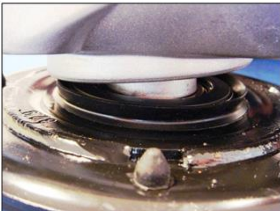
Einsetzen des Domlagers in die Halterung
