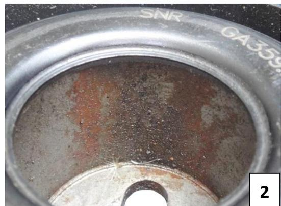
Il est très important de "clipser" le capuchon en plastique, qui assure l'étanchéité, sur le galet après le montage sur le véhicule (**Rep.3**), car la détérioration du roulement peut entraîner entre autre du bruit en fonctionnement.
