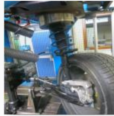
Верстат для здійснення тестів підвіски в тестовому центрі NTN Europe
