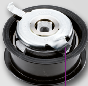
Appoggio superiore segnato o rotto
