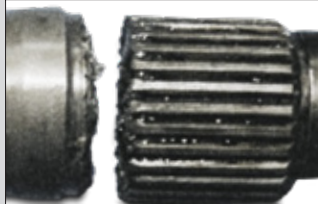
Bruch der Verbindungselemente
