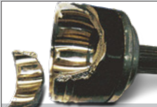
Bruch des Gelenkgehäuses
