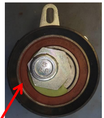
Ролик GT357.28 з обламаним валом
