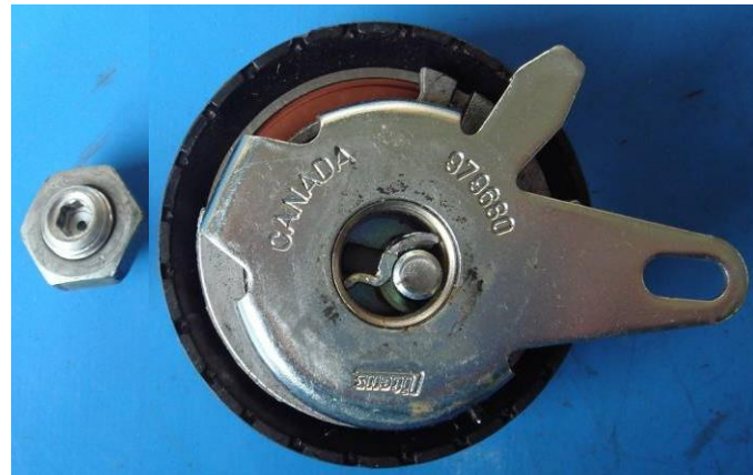
Ролик GT357.28 з обламаним валом
