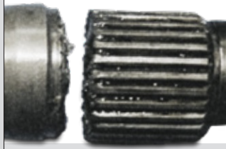
Bağlantı yivlerinin kırılması
