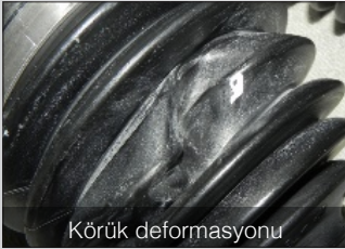
Burkulma = Körüğün tersine dönmesi veya körük deformasyonu
