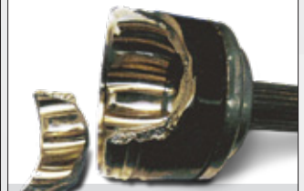
Aks çanağının kırılması
