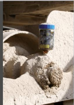
Благодаря компактному размеру Ready Booster может применяться для смазывания разных типов изделий: подшипников, подшипниковых корпусов, цепей, электродвигателей, вентиляторов, насосов, конвейеров и т.д.
