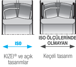
Şekil 19: KIZEI® rulman, açık oynak makaralı rulman ile aynı ISO genişliklerinde mevcuttur
