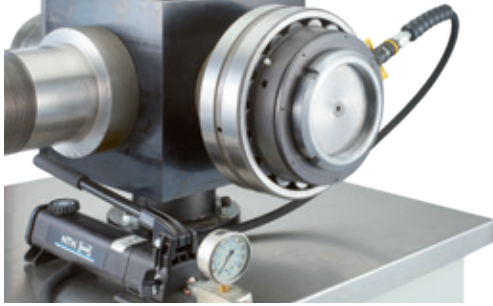
Adaptör manşonunun hidrolik somun ile sökülmesi
