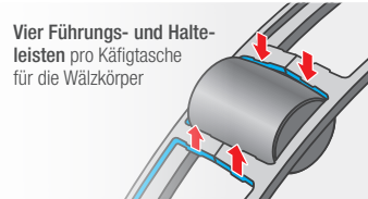
Abb. 9: Perfekter Lauf durch einzigartiges Führungssystem
