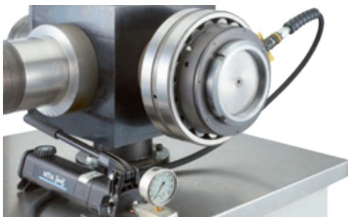
Extraction du manchon de serrage par l'écrou hydraulique
