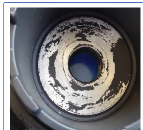
Сліди відколів на передній контактній поверхні шківа вказують на хибно затягнутий стопорний болт (див. малюнок згорі)
