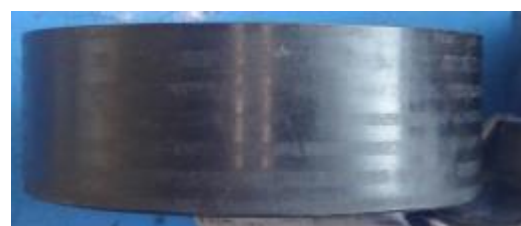
Следы на поверхности ролика
