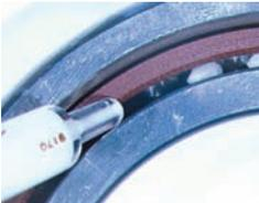
Füllen Sie das Fett mit einer Spritze oder einem Plastikspatel in gleichen Mengen zwischen die Kugeln. Richten Sie das Fett besonders auf die Laufbahn des Innenringes.
