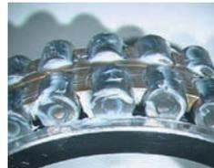
(Nach der Befüllung) Wenn ein Fettklumpen auf der Oberfläche des Käfigsteigs verbleibt, kann das Einlaufen länger dauern. Verteilen Sie das Fett mit den Fingern auf der Oberfläche des Stegs über den ganzen Käfig.
