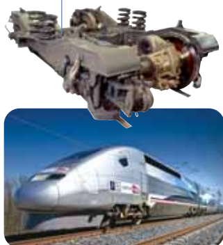
Букса скоростной поезд TGV duplex.
