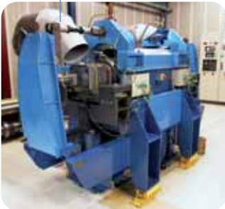
SNR-Prüfbank für Radlager.
