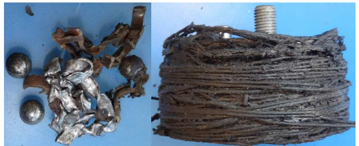
Consecuencias del deslizamiento de la correa
