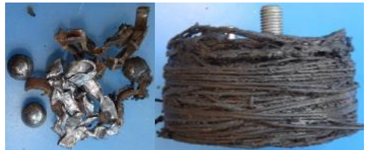
Gevolgen van een slippende riem
