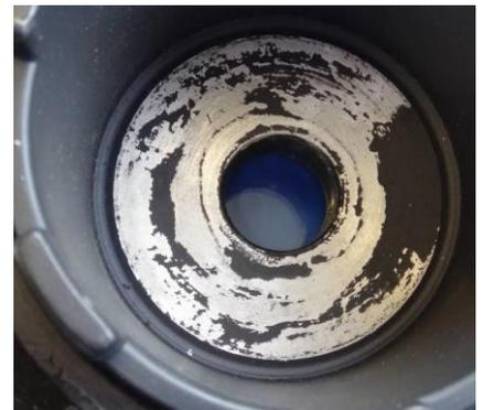
**Abplatzungen an der vorderen Kontaktfläche der Riemenscheibe weisen auf falsch angezogene Befestigungsschrauben hin.**
