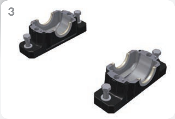
3 Insertar un semi- anillo metálico de sujeción conteniendo la banda de fieltro impregnada de aceite en cada una de las ranuras de estanquidad, sobre el semi-cordón tórico.
