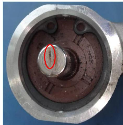
Marca sobre el vástago del cilindro
