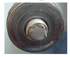
Люфт между роликом и двигателем вызывает нарушение натяжения ремня, а также его смещение.
