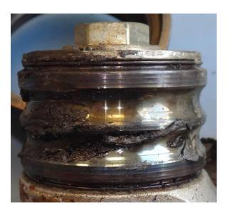
Теплопередача происходит по задней поверхности ремня (расплавленной по причине трения) к ролику, что приводит к увеличению температуры и ускоренному разрушению смазки и сепараторов подшипника в ролике. Это приводит к разрушению натяжного ролика.
