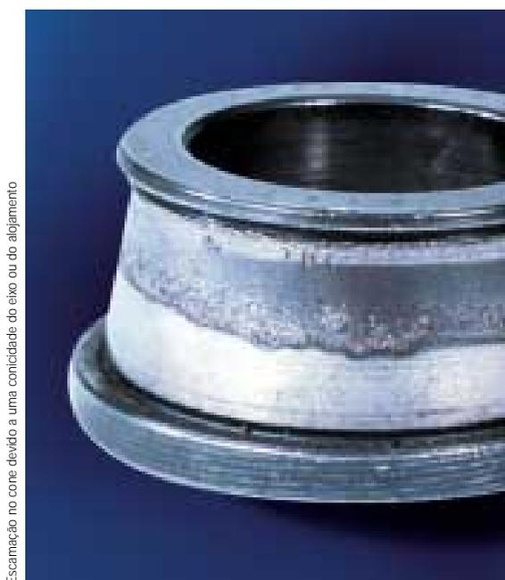
Escamação no cone devido a uma conicidade do eixo ou do alojamento
