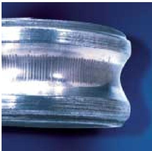
Arco elétrico no anel interno
