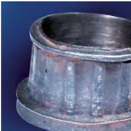
Gripagem de um rolamento autocompensador de rolos, incrustação de rolos e ruptura de borda
