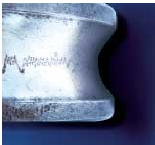
Arco eléctrico sobre el anillo interior
