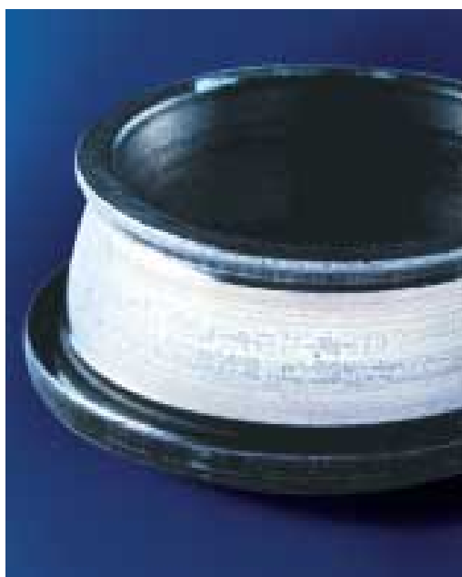
Exfoliación superficial debida a una viscosidad demasiado baja
