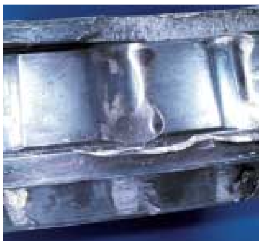
Gripado de un rodamiento de rodillos a rótula, incrustación de rodillos y ruptura de collarín
