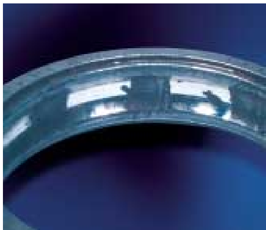
Oxidación durante la parada (entrada de líquido)
