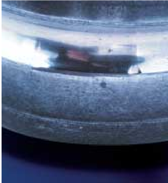
Marcas debidas a un montaje en el eje con apoyo sobre el anillo exterior
