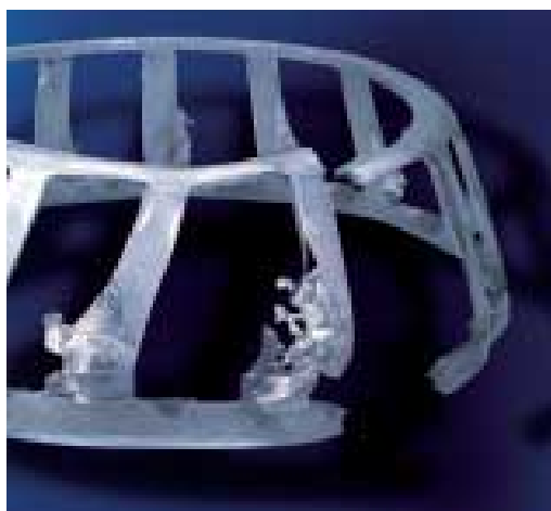
Deterioro de la jaula debido a un comienzo de gripado
