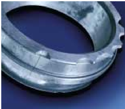
Roturas debidas a un montaje con golpes
