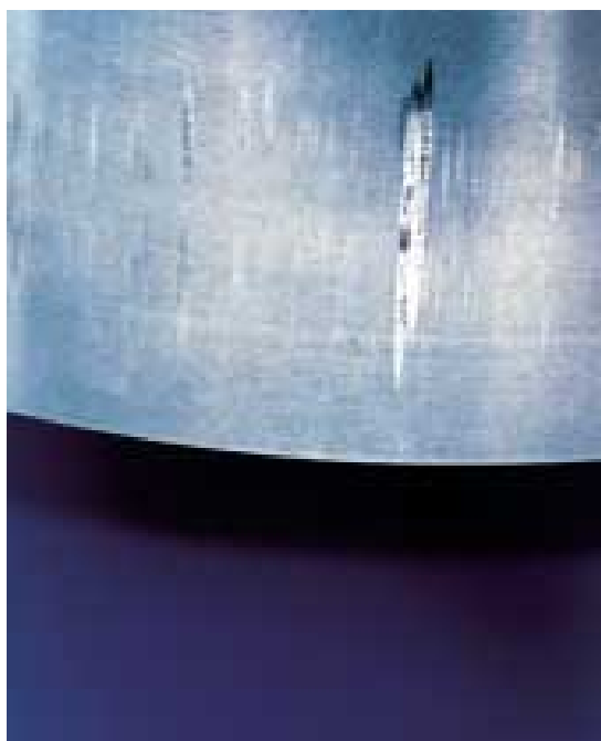
Falso efecto Brinell sobre un rodamiento de rodillos
