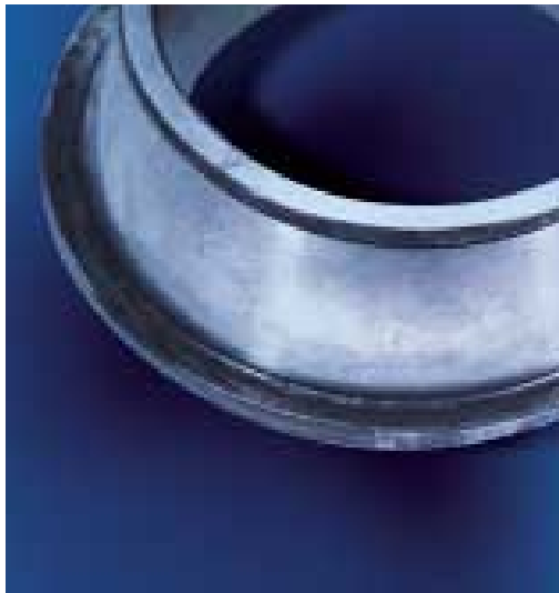
Deterioro del collarín debido a un exceso de precarga
