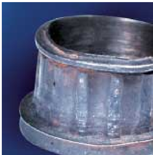
Gripado de un rodamiento cónico con incrustación de los rodillos
