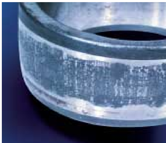
Oxidación en funcionamiento (entrada de líquido)
