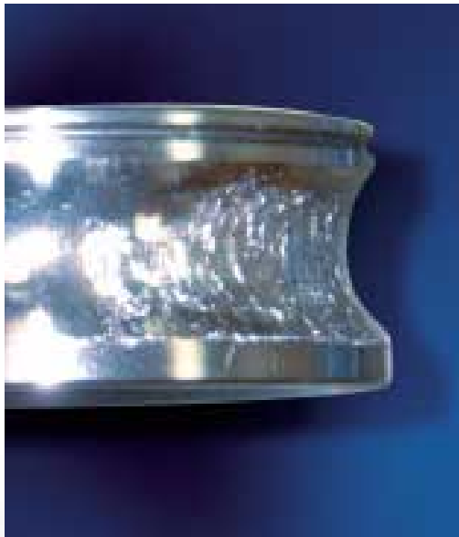
Funcionamiento en sobrecarga axial
