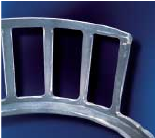
Rotura de la jaula por vibraciones
