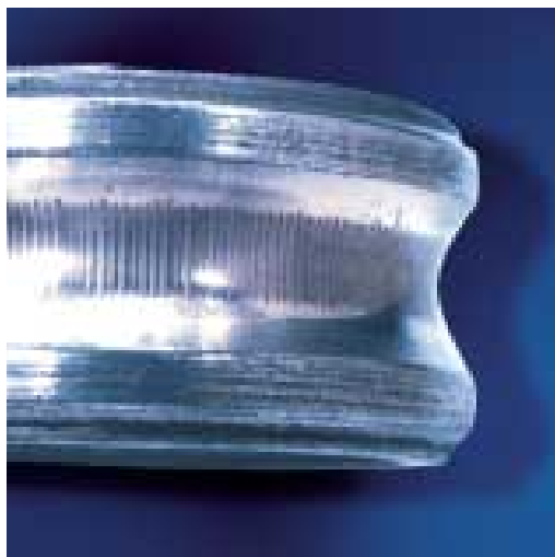
Paso de corriente eléctrica en el anillo interior en rotación
