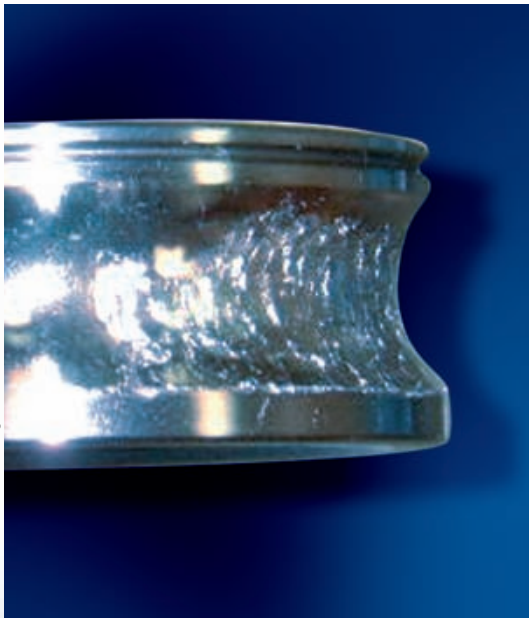
Betrieb bei axialer Überlastung
