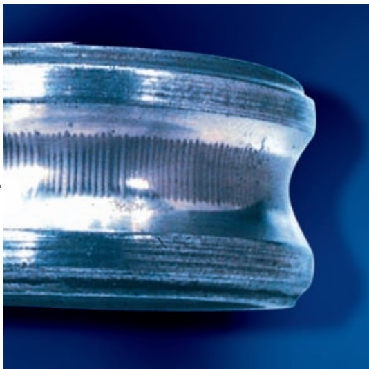
Stromdurchfluss in rotierendem Innerring
