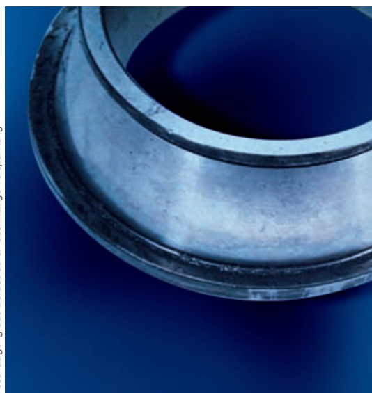
Beschädigung des Bordes durch übermäßige Vorspannung
