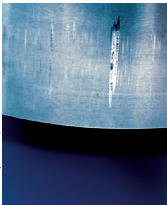
Falsche Brinellierung in einem Rollenlager
