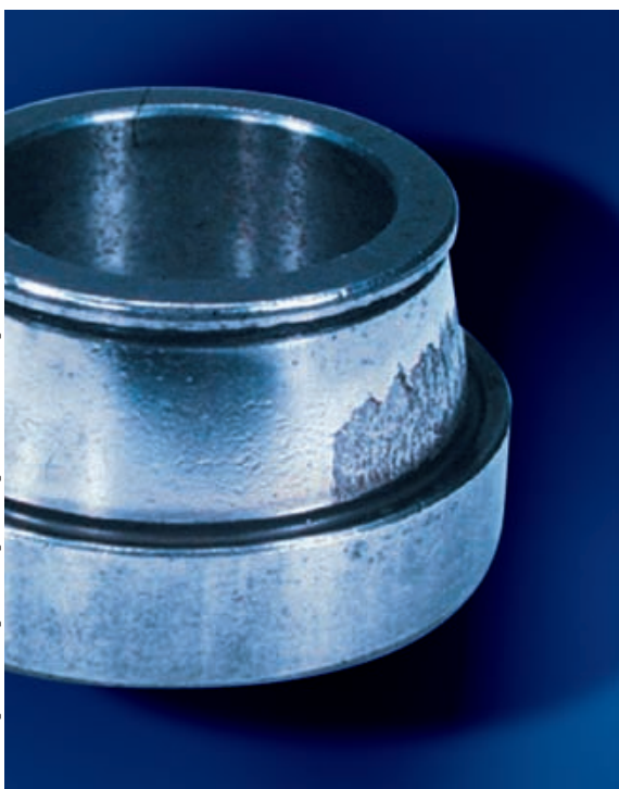
Abschälung an Innenring eines Kegelrollenlagers durch Fluchtungsfehler
