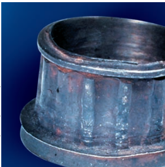
Fressen bei Kegelrollenlager mit Eindringen an der Rollen
