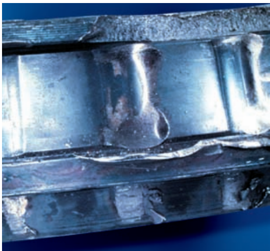
Fressen in Pendelrollenlager, Eindringen der Rollen und Bruch des Innenbordes
