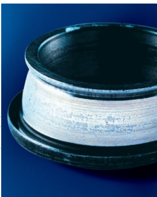
Oberflächliche Abschälung durch zu geringe Viskosität
