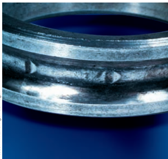
Fressen mit Eindringen der Kugeln
