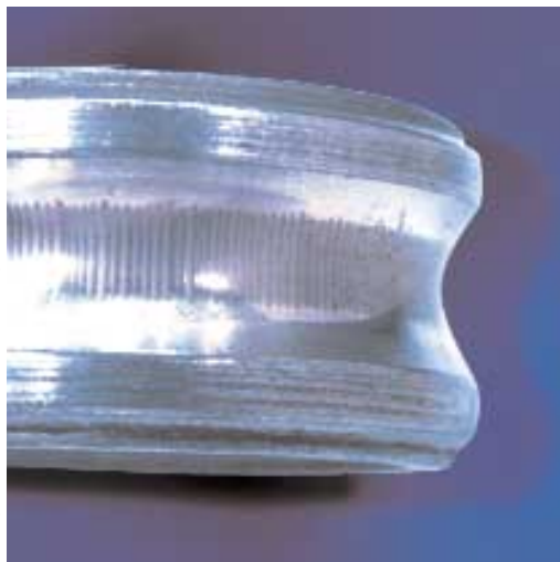
Passage de courant électrique dans la bague intérieure en rotation
