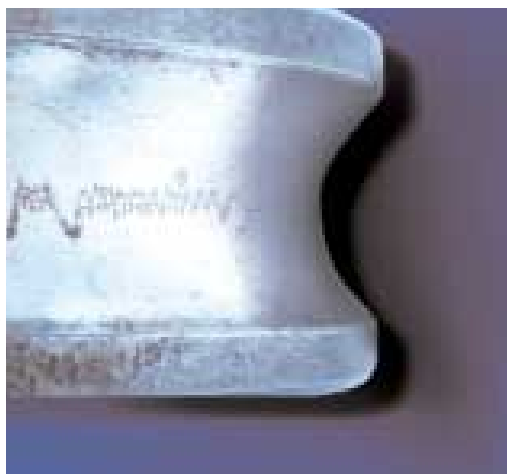
Arc électrique sur la bague intérieure
