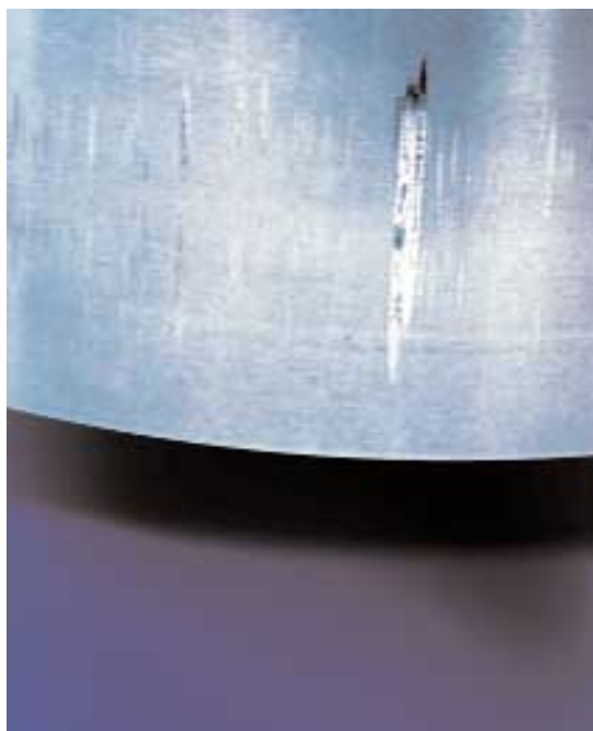
Faux effet Brinell sur un roulement à rouleaux
