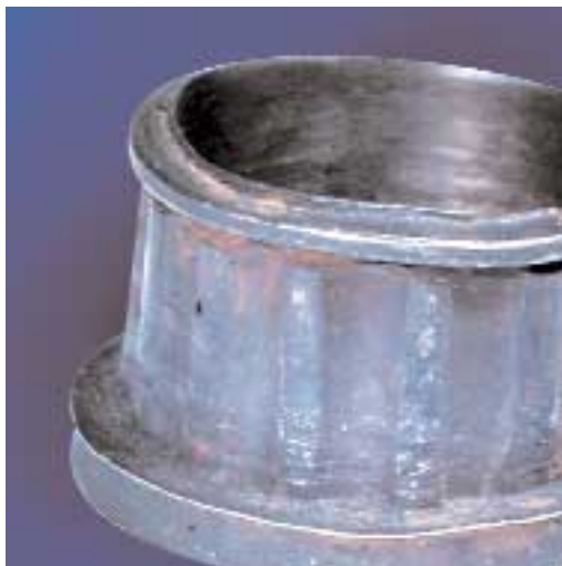
Grippage d'un roulement conique avec incrustation des rouleaux
