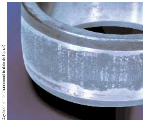
Oxydation pendant l'arrêt (entrée de liquide)
