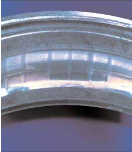
Faux effet Brinell sur un roulement à billes
