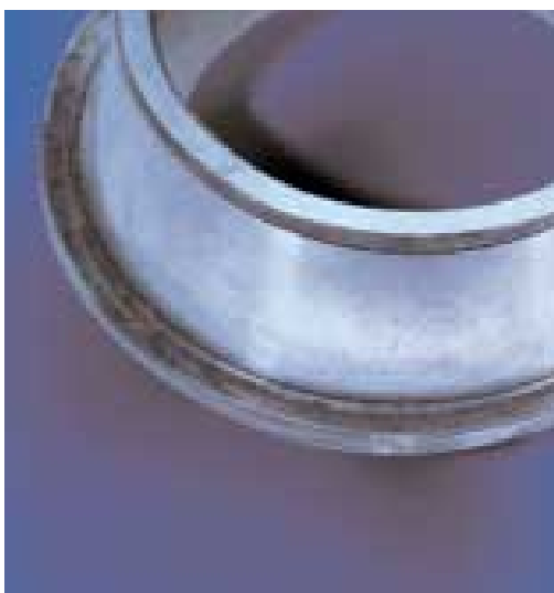
Détérioration de la collerette due à un excès de précharge
