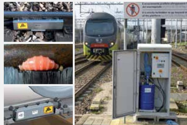
Le système TRACK-LUBE a été développé pour assurer la lubrification dans les courbures de rail et atténuer l'usure des roues comme du rail lui-même.
